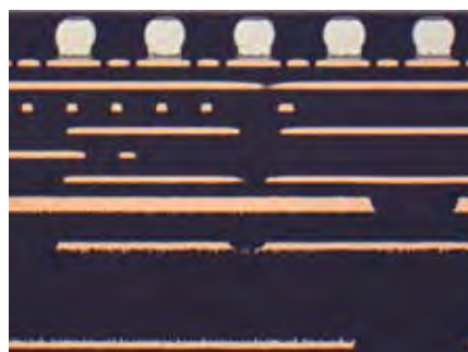
Массив шариков BGA, поперечное сечение, 100x
