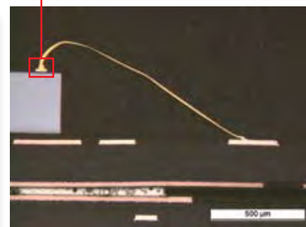
Обзор и детализация, диаметр золотого провода 20 мкм
