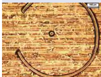
Слой хрома, осажденного из паровой фазы на стали, возможное место коррозии, 50-кратное увеличение
