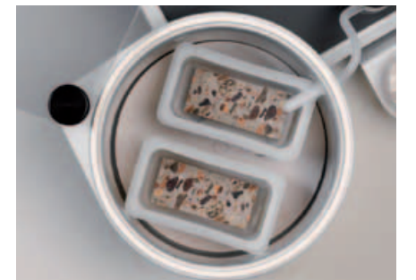
Большая вакуумная камера для крупных образцов
