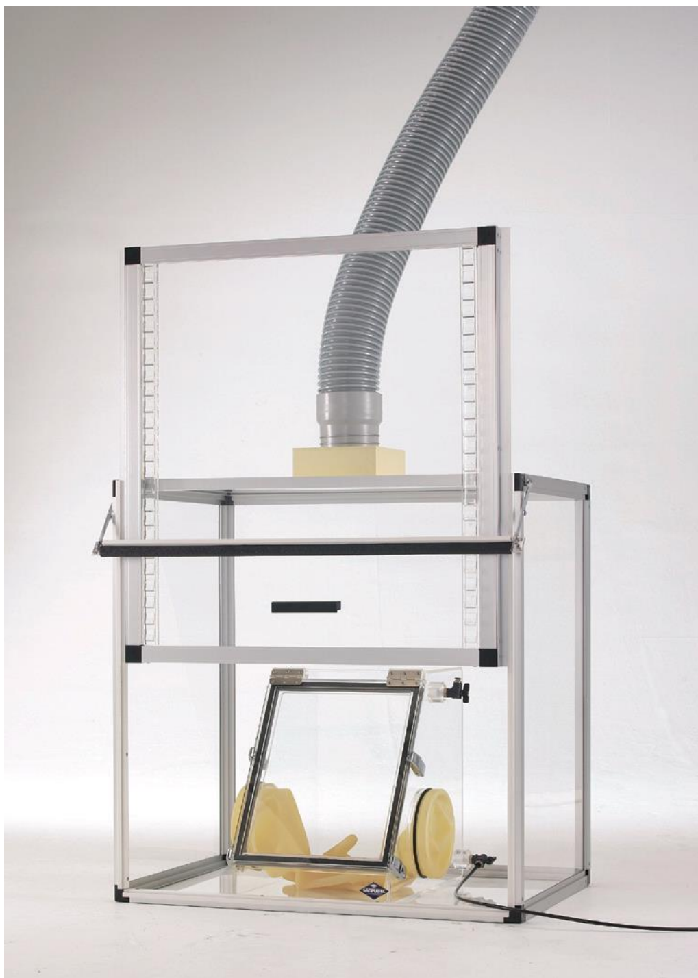
Перчаточный бокс GBC, установленный в вытяжном шкафу F-1000H
